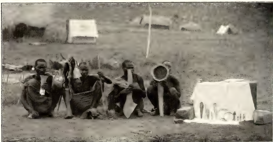
Abb. 326. Blasebalg in seine Bestandteile zerlegt; rechts Handwerkszeug der Schmiede.
